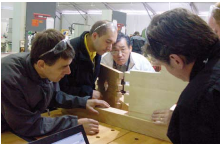
A zsűri előbb „szárazon” vizsgálta a csapozások illeszkedését és pontos méreteit, csak ezt követően lehetett a ragasztást elvégezni
